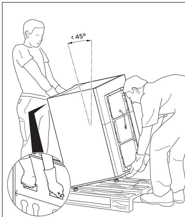
Мал. 4.6 Транспортування установки в зборі (перенос)
